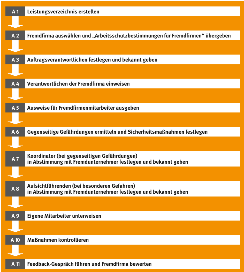
Bild 2-1: Fremdfirmeneinsatz aus der Sicht des Auftraggebers
